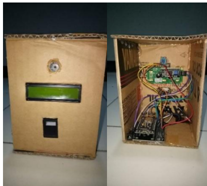
Gambar 2. Prototipe alat sistem presensi dan screening kesehatan berbasis IoT
